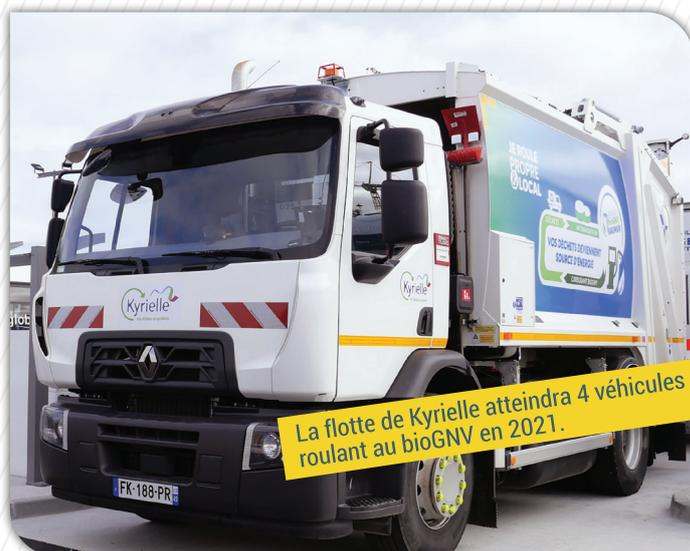
Le BioGNV est la version renouvelable du GNV (Gaz Naturel pour Véhicules). Ce gaz vert a les mêmes caractéristiques que le GNV, mais est obtenu grâce à la méthanisation de déchets organiques. Il est produit localement à Chacé, à partir de déchets agricoles. Le BioGNV, c'est 80% d'émission de gaz à effet de serre en moins que le gasoil et 90% de moins d'émission de particules fines.
