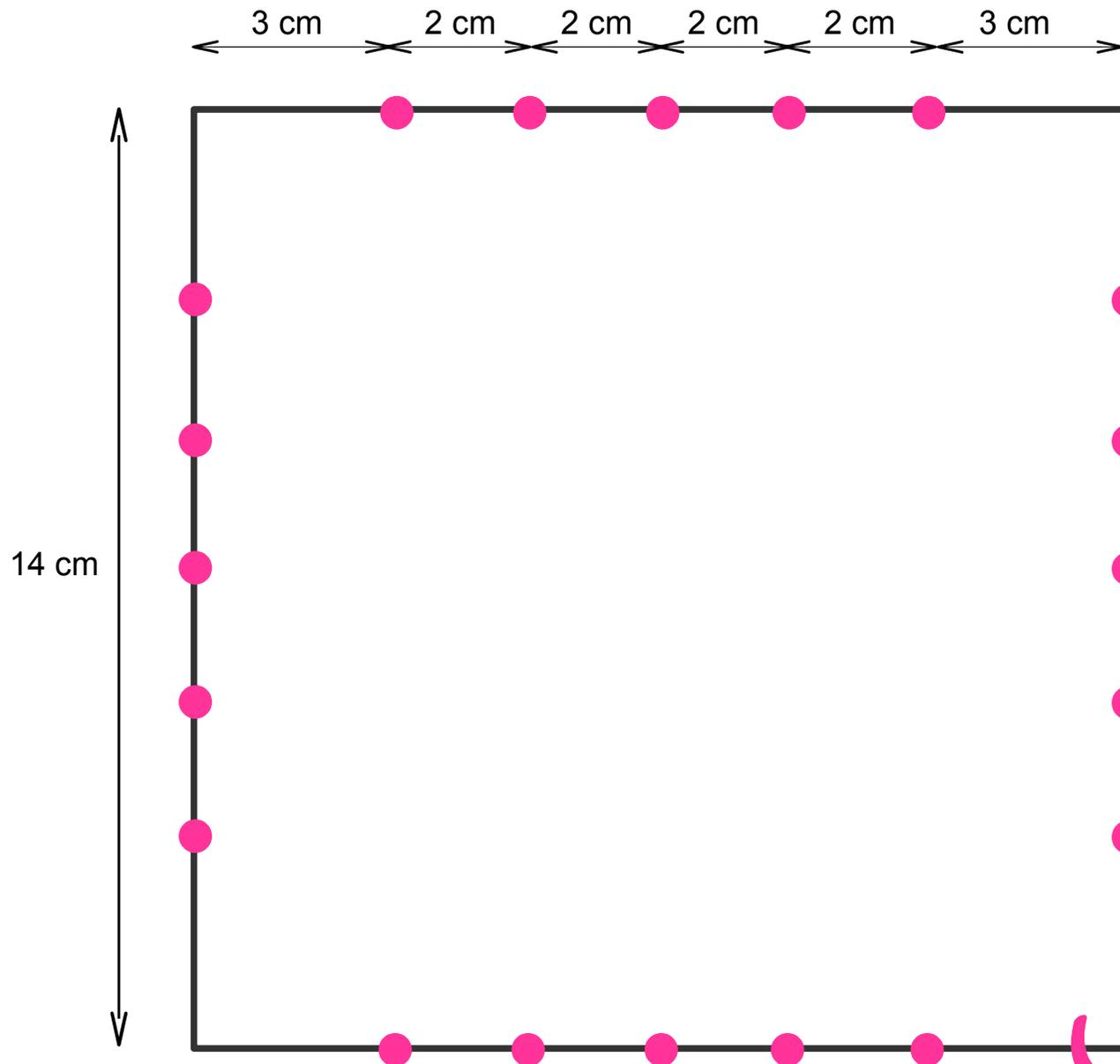
Tracez un carré de 14 centimètres de côté sur la planche. Plantez un clou à 3 centimètres de chaque angle puis plantez les autres clous à 2 centimètres les uns des autres.
